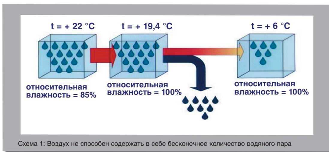
относительной влажности охлаждается вблизи холодной трубы, если средняя температура трубы ниже температуры окружающего воздуха.
